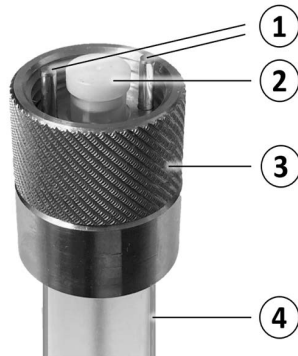
Figure 5-1 Dispositif d'échantillonnage manuel 1 : Goupilles de positionnement, 2 : Bouchon, 3 : Bague de fixation, 4 : Tube à bouchon fileté de 5 ml.
